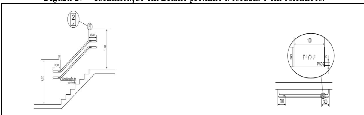
Figura 17 - Identificação em Braille próximo a escadas e em corrimões.
