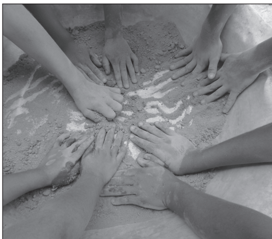
Figura 1 – Preparo da argila, barro moído e peneirado
